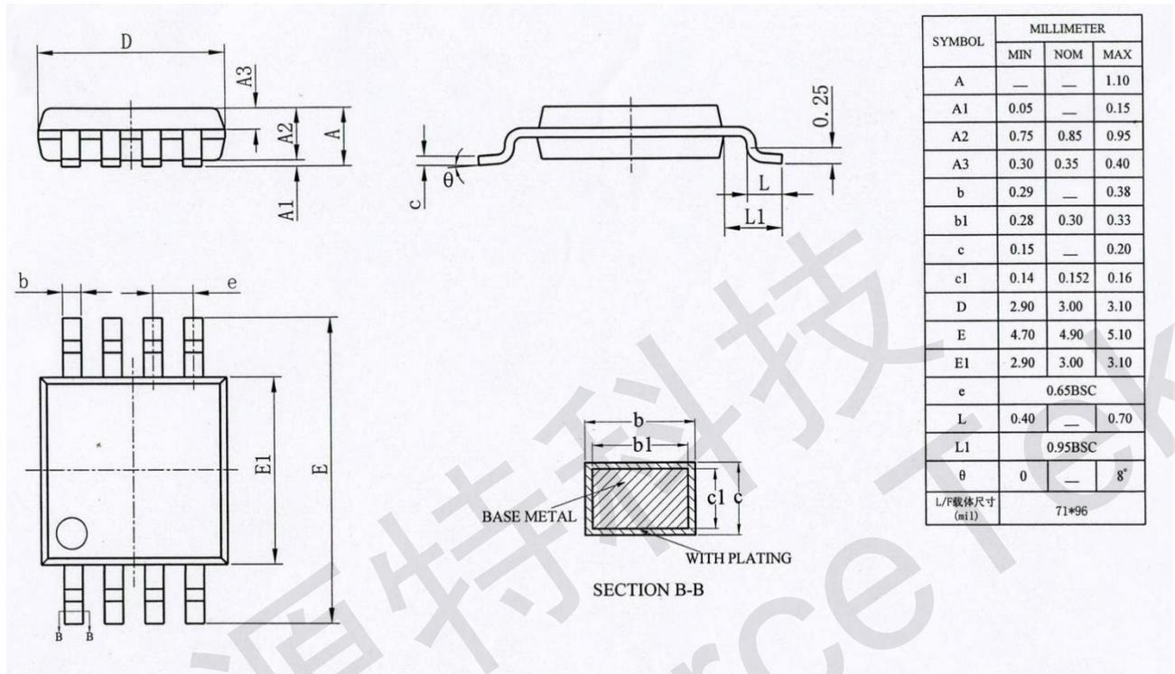
图 1 MSOP-8 封装尺寸图
